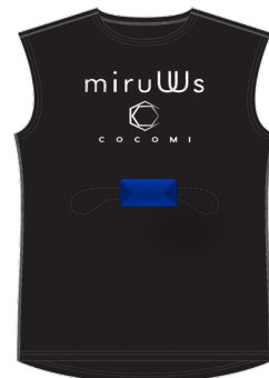
図 5 ミルウス社が試作した下着型センサ (センサヘッドは東洋紡の CoCoMi を用いた)
