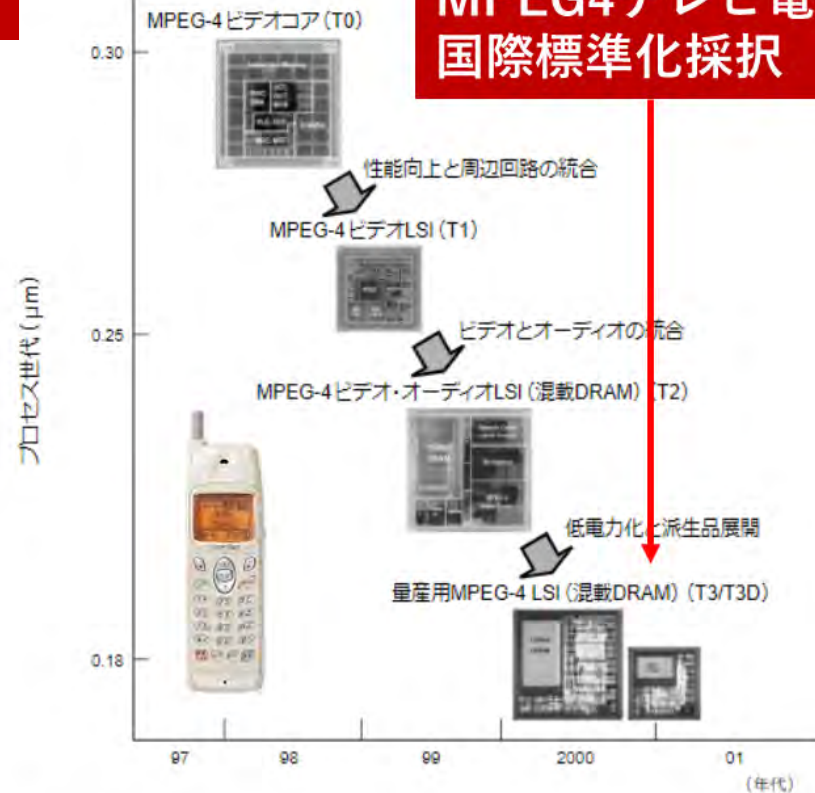
図6. 当社のMPEG-4符号化LSI (Tシリーズ)の開発経過 — 携帯電話端末用に搭載するため、MPEG-4ビデオ処理に適したアーキテクチャの採用とDRAMの混載により、低消費電力化を図ったのが特長である。
